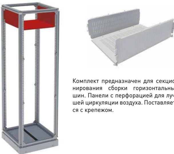
Комплект предназначен для секционирования сборки горизонтальных шин. Панели с перфорацией для лучшей циркуляции воздуха. Поставляется с крепежом.
