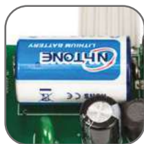
Часы реального времени работают 10 лет без питания
