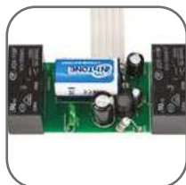
Два встроенных реле на токи до 16 А
