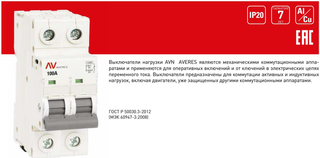
Выключатели нагрузки AVN AVERES являются механическими коммутационными аппаратами и применяются для оперативных включений и отключений в электрических цепях переменного тока. Выключатели предназначены для коммутации активных и индуктивных нагрузок, включая двигатели, уже защищенных другими коммутационными аппаратами.
