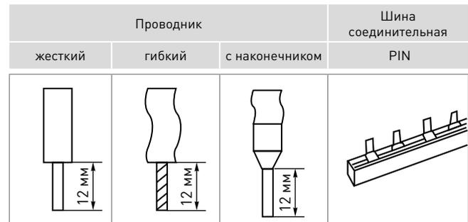
2. Монтаж и подключение выключателя нагрузки должны осуществляться квалифицированным электротехническим персоналом. Выключатель нагрузки монтируется на DIN-рейку 35 мм. Момент затяжки винтов 2,5 Н·м. Диапазон рабочих температур от –40 до +50°C. Высота над уровнем моря – не более 2000 метров. Положение в пространстве – на вертикальной плоскости вертикальное или горизонтальное. Возможна коммутация алюминиевым и медным проводником.
