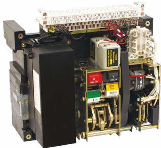
Выключатели нагрузки серии ВН-45 PROxima являются воздушными выключателями с механизмом свободного расцепления и оперирования контактами посредством механизма с пружинным накопителем энергии.
