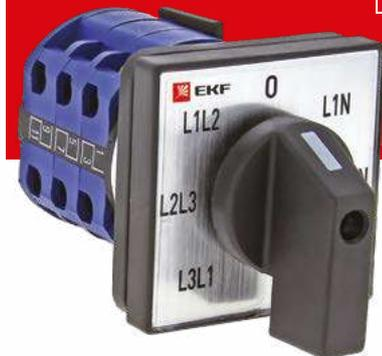
Кулачковые переключатели ПК PROxima представляют собой механические коммутационные аппараты, рассчитанные на применение в цепях переменного тока номинальным напряжением до 400 В и частотой 50/60 Гц. Благодаря повышенному содержанию серебра в контактах достигается их пониженное переходное сопротивление и повышенная устойчивость к воздействию внешней среды.
